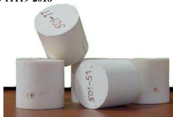
Рисунок 31 – Внешний вид стандартных образцов открытой пористости твердых веществ горных пород ГСО 11116-2018/ГСО 11119-2018
