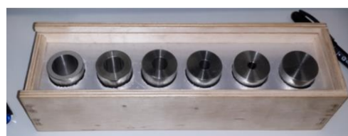
Рисунок 30 – Внешний вид комплекта стандартных образцов открытой пористости твердых веществ, материалов ГСО 10583-2015
