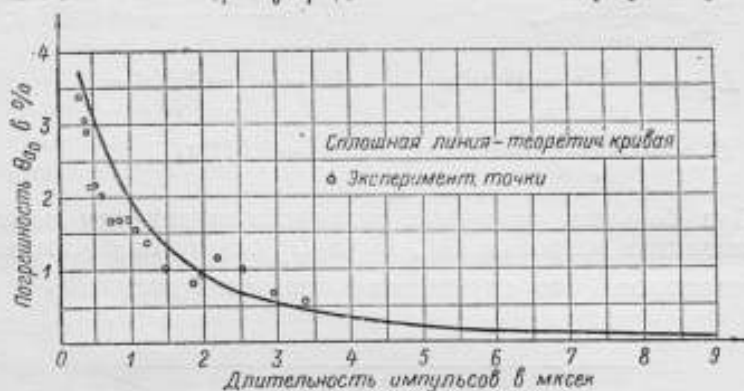
Фиг. 15. Зависимость погрешности \theta_{\sigma_0} от длительности импульсов при синусоидальной форме импульсов при R = 5000 \text{ ом}
