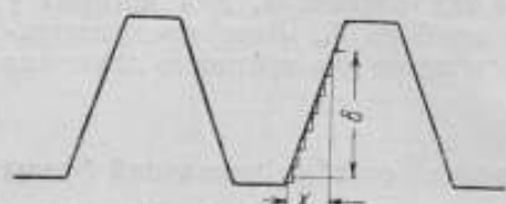
Рис. 7. Схема измерения прямолинейности профиля и угла.
