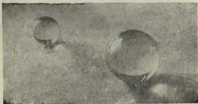
Рис. 5. Кварцевые гири в форме шаров.
