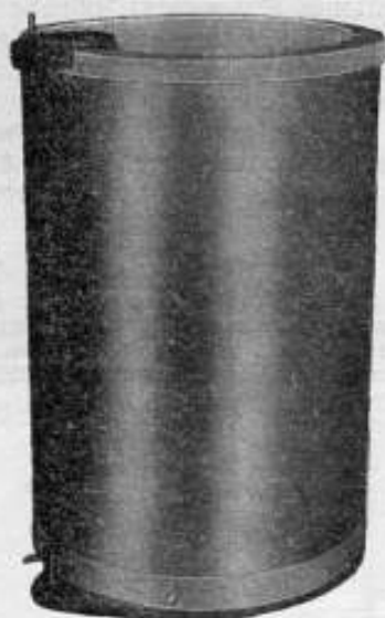
Общий вид одной из катушек первичного эталона единицы индуктивности.
