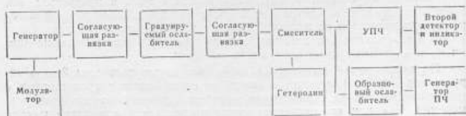
Рис. 4. Блок-схема измерения супергетеродинным методом
