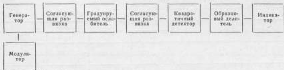
Рис. 3. Блок-схема измерения методом квадратичного детектора
