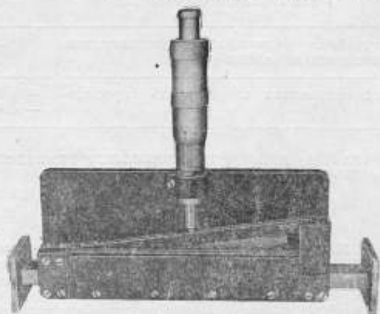
Рис. 1. Ослабитель ножевого типа со снятым кожухом
