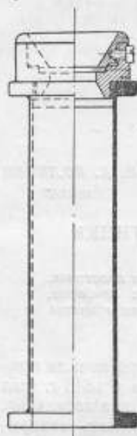
Рис. 1. Пластинка в оправе с направляющей трубкой.
