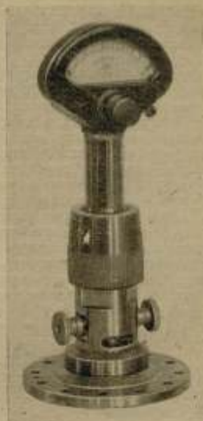
Рис. 4. Устройство для испытания пружинных измерительных головок
