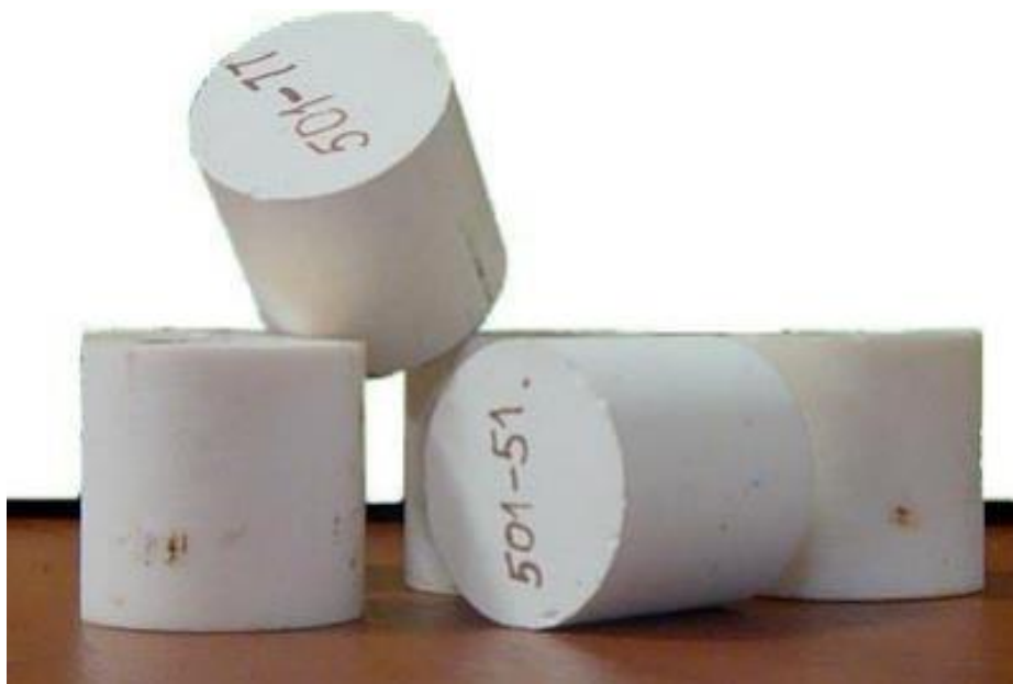
Рисунок 3.74–Внешний вид стандартных образцов открытой пористости твердых веществ горных пород ГСО 11116-2018/ГСО 11119-2018
