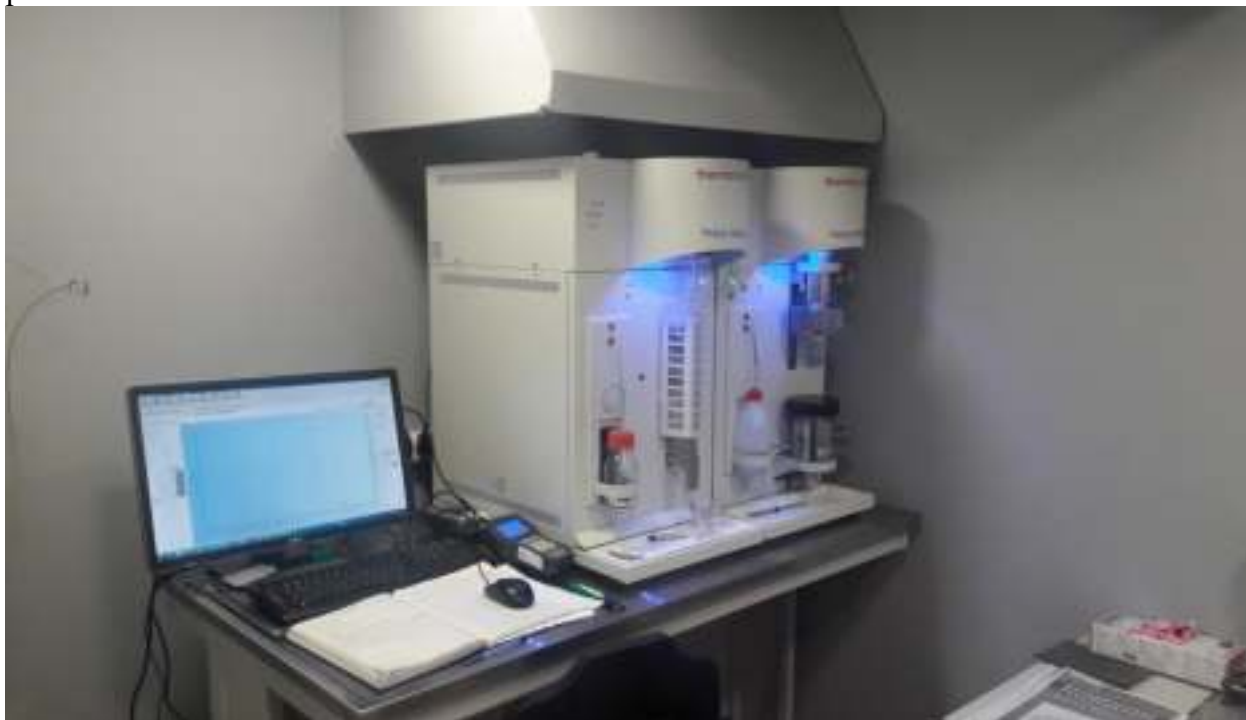
Рисунок 2.36 - Внешний вид ЭУ, реализующей метод ртутной порометрии
