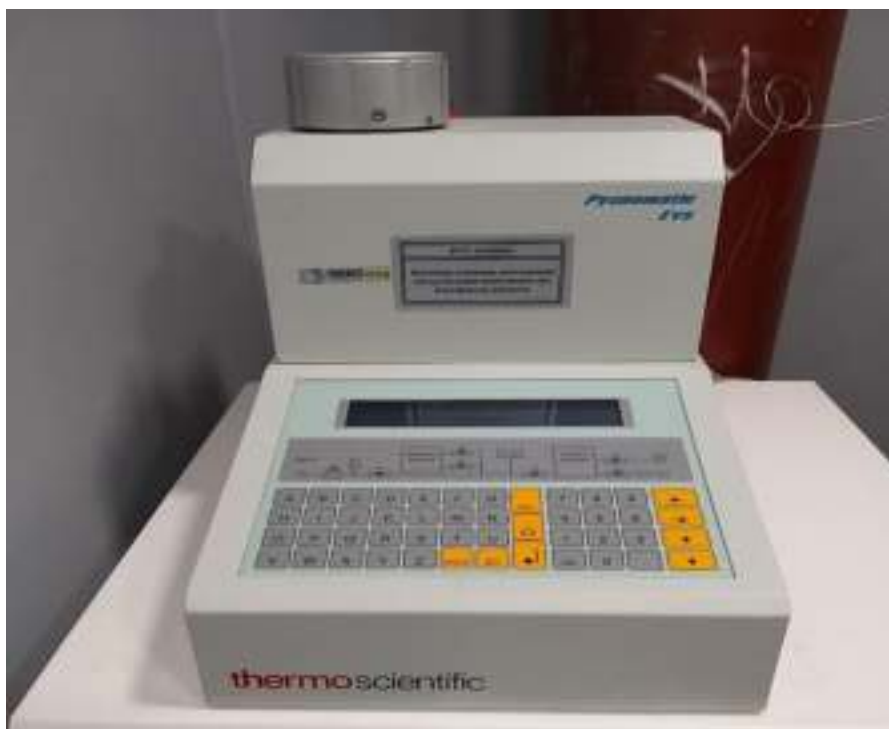
Рисунок 2.43 - Внешний вид ЭУ, реализующей метод гелиевой пикнометрии для воспроизведения открытой пористости при атмосферном давлении
