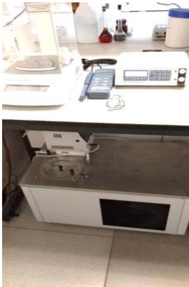
Рисунок 2.41 - Внешний вид ЭУ, реализующей метод гидростатического взвешивания
