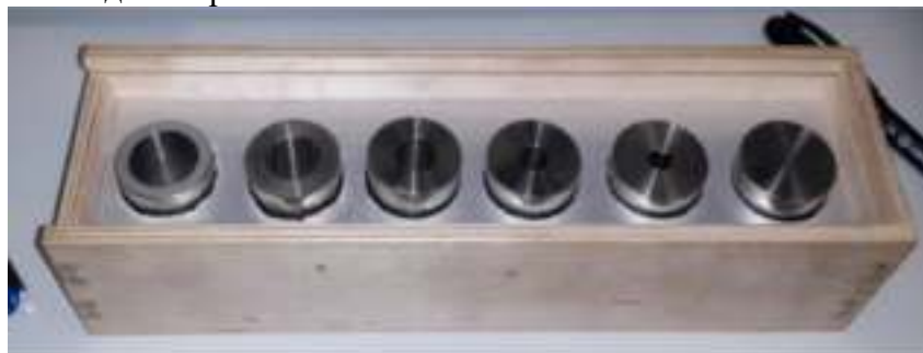
Рисунок 3.73 – Внешний вид комплекта стандартных образцов открытой пористости твердых веществ, материалов ГСО 10583-2015
