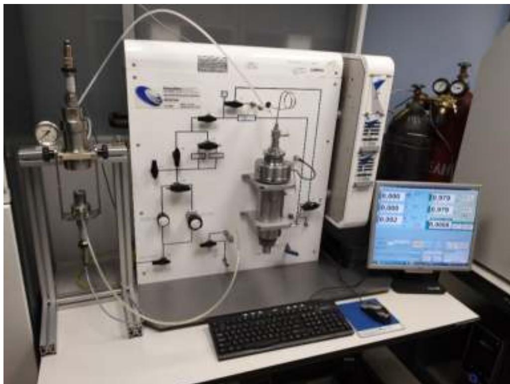
Рисунок 2.46 - Внешний вид ЭУ, реализующей метод стационарной фильтрации и гелиевой пикнометрии для воспроизведения коэффициента газопроницаемости и открытой пористости твердых веществ в пластовых условиях при давлении (2-3) МПа
