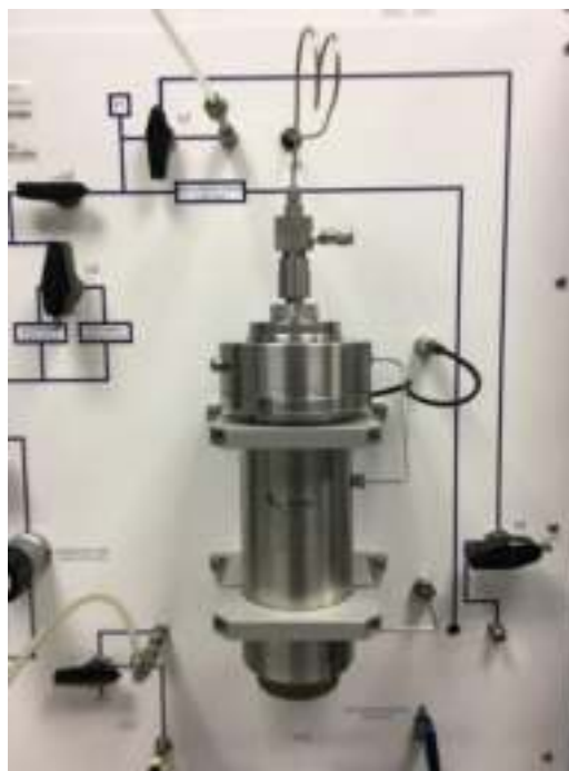
Рисунок 2.49 – Внешний вид кранов для управления анализатором при измерении открытой пористости на ЭУ
